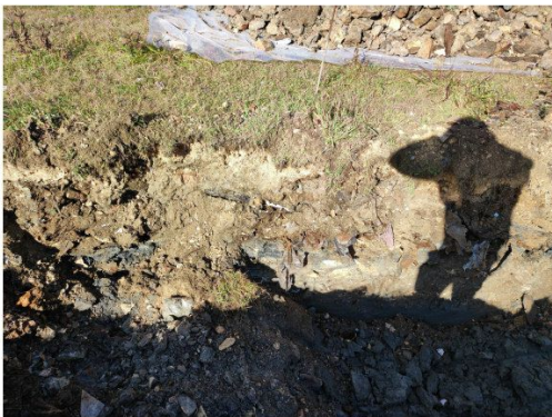
Foto 1 - Trincea TRS13 – fasi di realizzazione dello scavo con rinvenimento dell'orizzonte di rifiuto.
