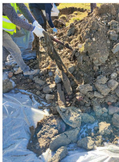
Foto 7 - Trincea TR7 fasi di campionamento del rifiuto.
