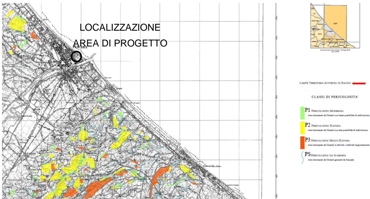
Fig.11 Stralcio carta della pericolosità da frana del Piano Stralcio per l'assetto idrogeologico
