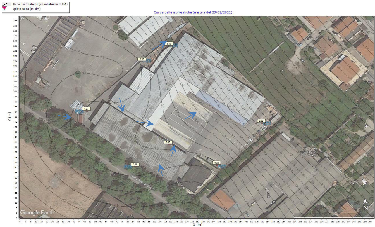
Figura 3 – Carta delle isofreatiche (misure del 23.03.2022, la freccia indica il verso principale del deflusso)
