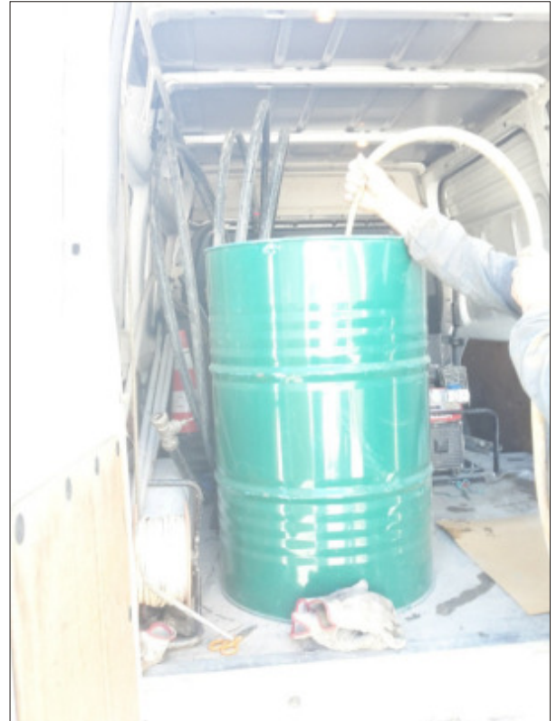
3) Contenitore in acciaio utilizzato per la raccolta delle acque di spurgo
