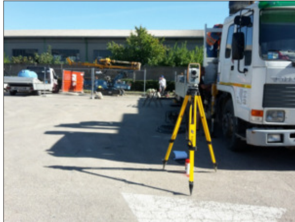
1) Stazione totale utilizzata per il rilievo topografico
