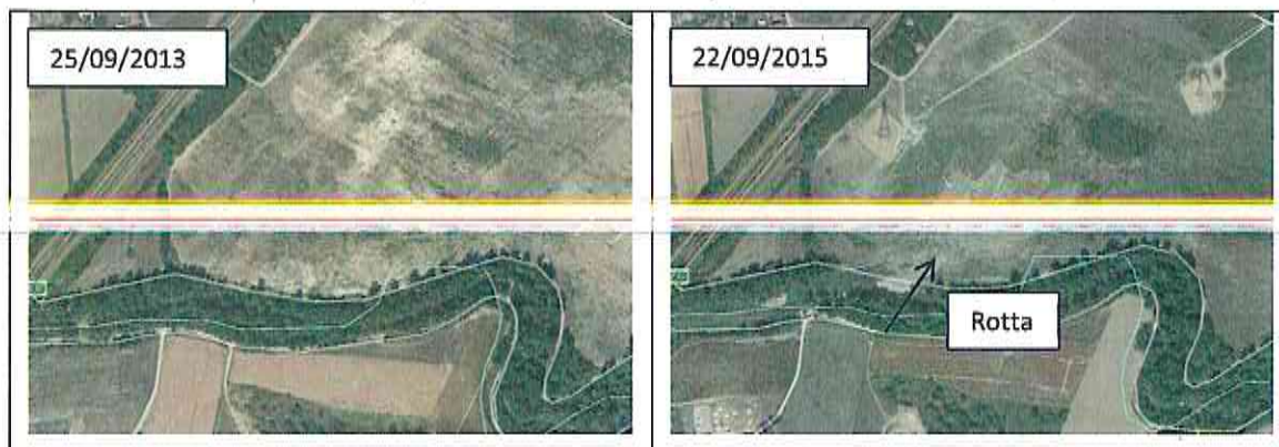
Figura 5.17 – Confronto tra ortofoto dell'area a valle dell'A25- sinistra idraulica.
