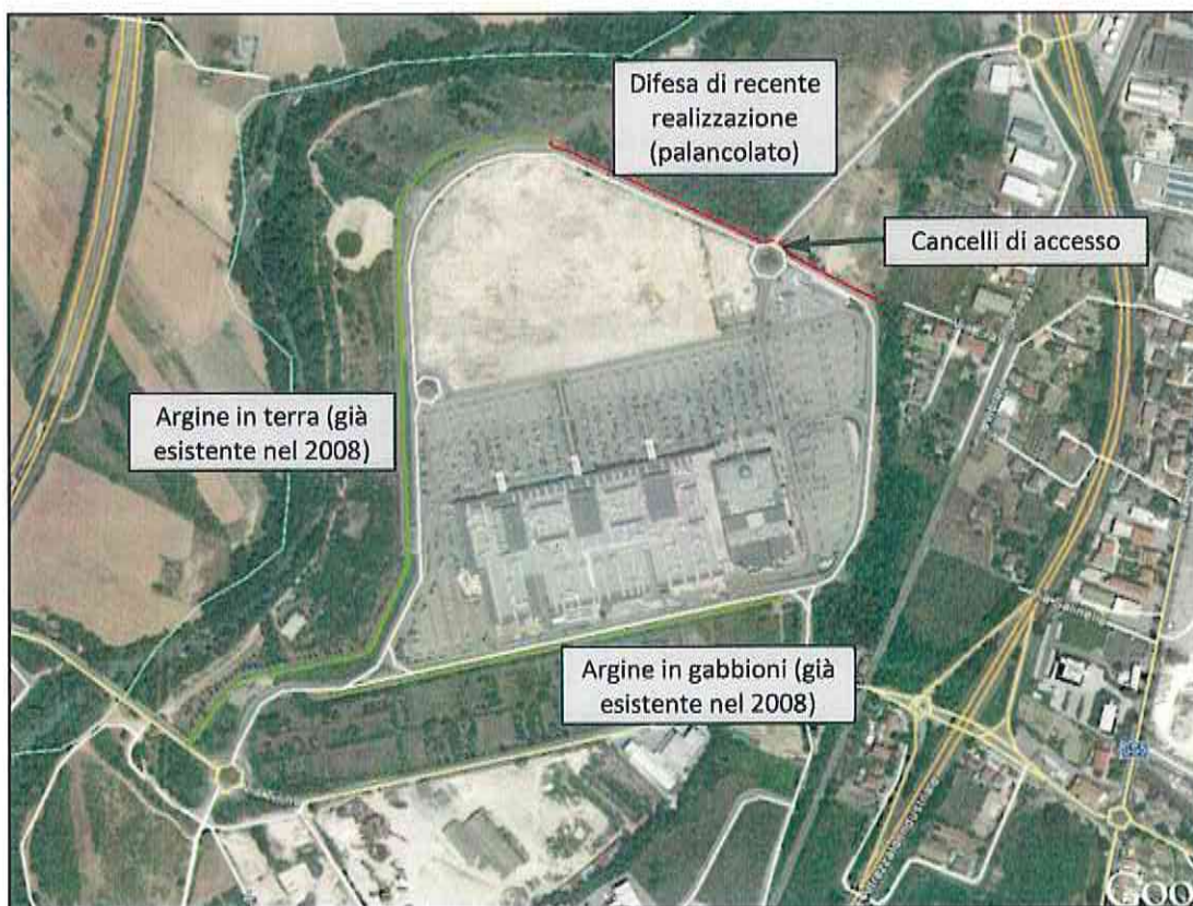
Figura 3.3 – Posizione planimetrica dell'argine già esistente nel 2008 (in verde) e del palancolato di recente realizzazione (in rosso).
