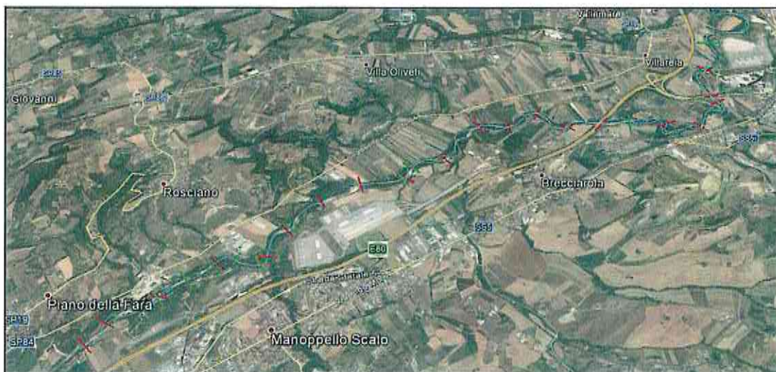
Figura 3.23 – Area interessata dalle campagne di rilievi topografici eseguite nell’ambito dei progetti delle “Opere di laminazione delle piene del fiume Pescara” con indicazione delle sezioni d’alveo rilevate per la redazione del Progetto Definitivo (2015 – in rosso) ed Esecutivo (2017 – in verde).
