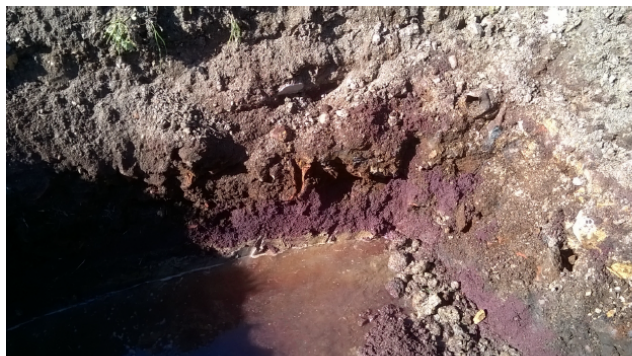
Fig. 1 - Trincea con probabili ceneri di pirite fino a quota falda
