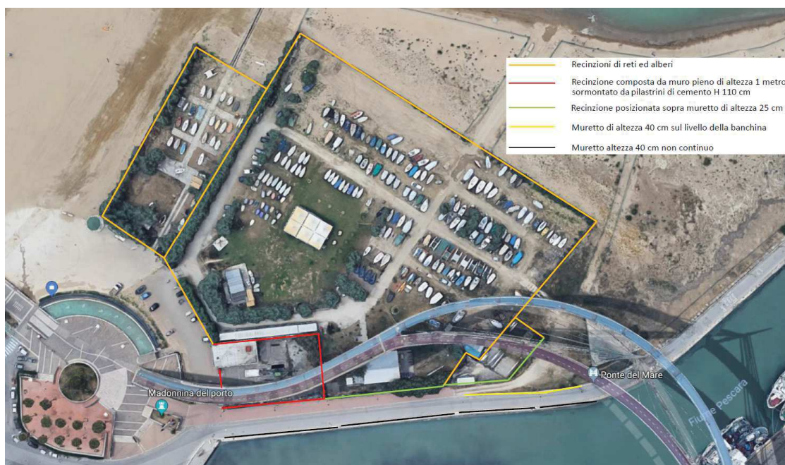
Figura 2.3 Planimetria della configurazione attuale della Lega Navale con evidenziate le differenti tipologie presenti di recinzione perimetrale.
