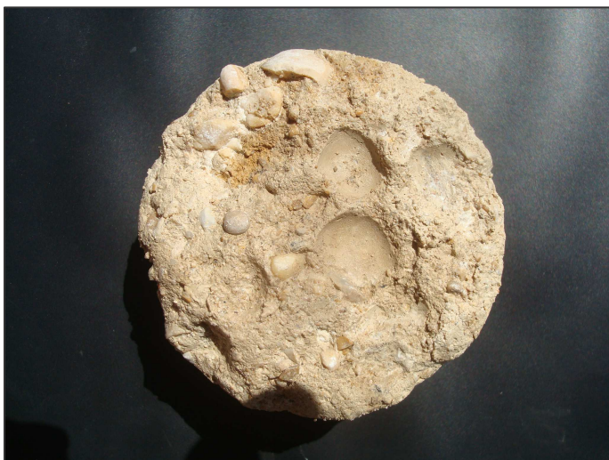
FOTOGRAFIA 3: ghiaia con sabbia, campione prelevato in S1Pz6 a circa 4,3 m di profondità (prima fase di studio, 2014)
