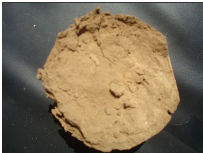
FOTOGRAFIA 2: limi sabbiosi/con sabbia, campione prelevato in S1-Pz6 a circa 2,3 m di profondità (prima fase di studio, 2014)
