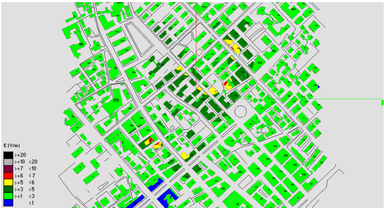
Fig. 203 Impatto elettromagnetico – Zona Via Fonzi - via Croce – Vista dall'alto
