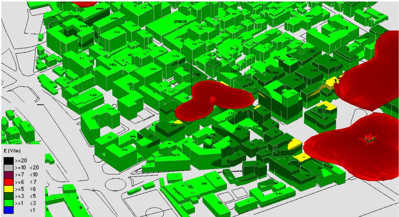
Fig. 257 Impatto elettromagnetico – Zona Via L'Aquila - Via Napoli – 0°/Nord
