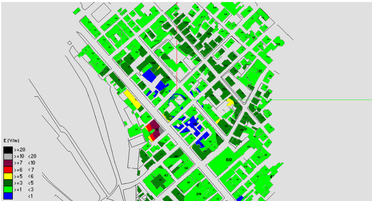
Fig. 98 Impatto elettromagnetico – Zona Via Genova Via Milano – Vista dall'alto
