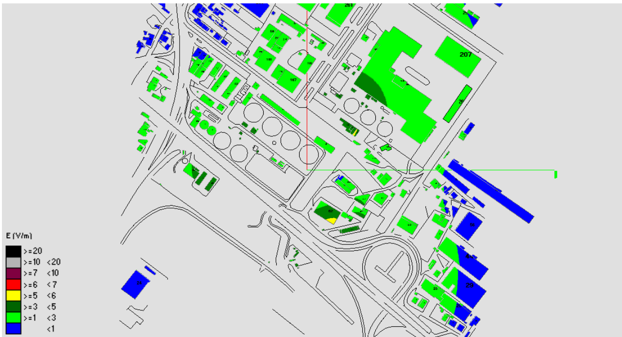
Fig. 273 Impatto elettromagnetico – Zona Area Depuratore – Vista dall'alto
