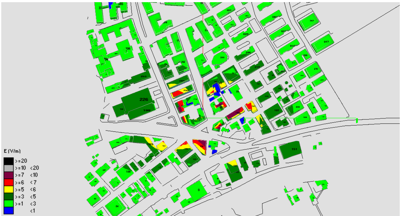
Fig. 148 Impatto elettromagnetico – Zona Via Malagrida – Vista dall'alto
