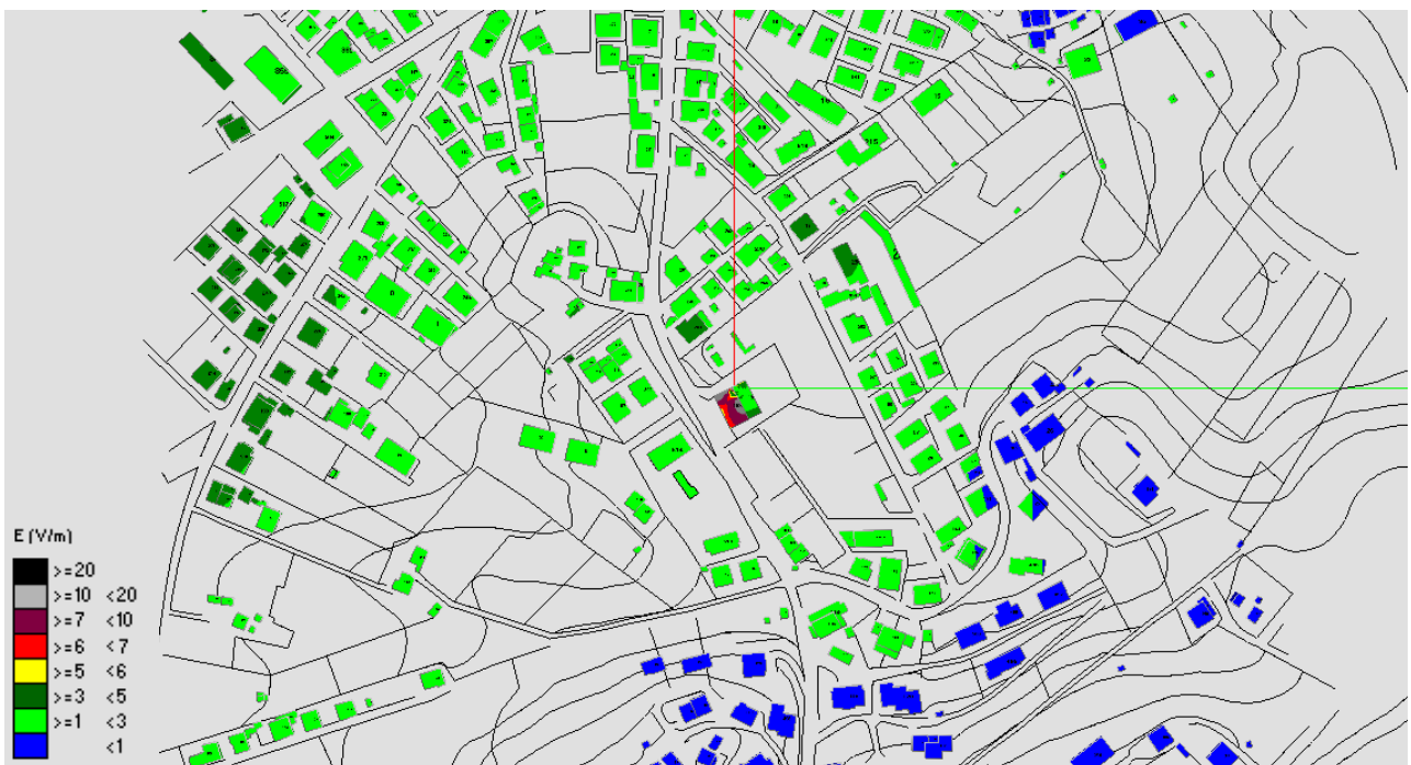
Fig. 243 Impatto elettromagnetico – Zona Via San Donato – Vista dall'alto
