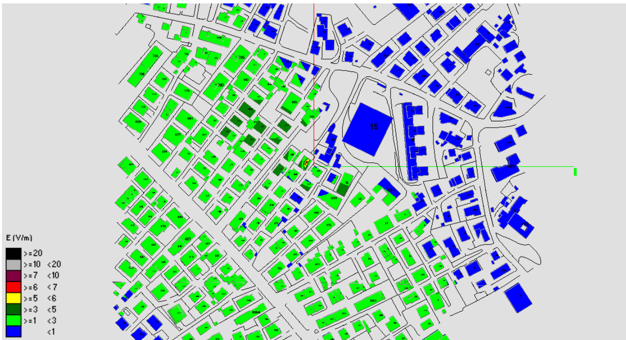
Fig. 63 Impatto elettromagnetico – Zona Via di Francesco – Vista dall'alto
