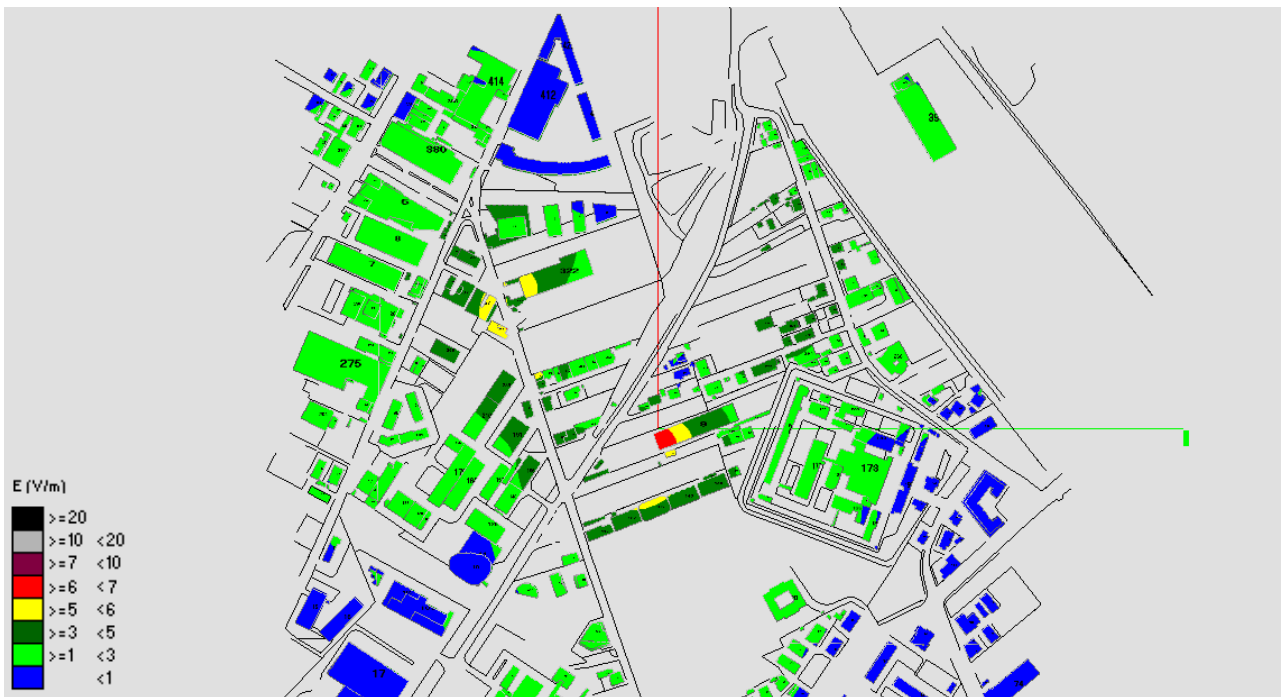
Fig. 176 Impatto elettromagnetico – zona Via Alento Via Tirino – Vista dall'alto
