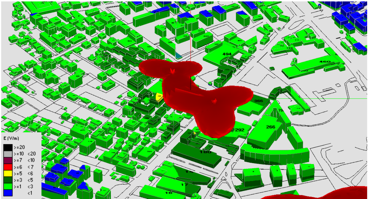
Fig. 140 Impatto elettromagnetico – zona Via Tiburtina – 0°/Nord
