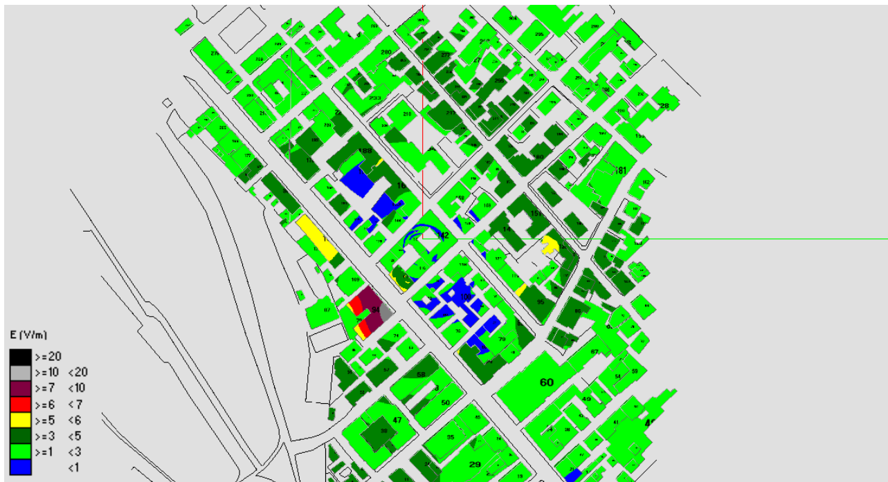
Fig. 86 Impatto elettromagnetico – zona Via Genova – Via Milano – Vista dall'alto
