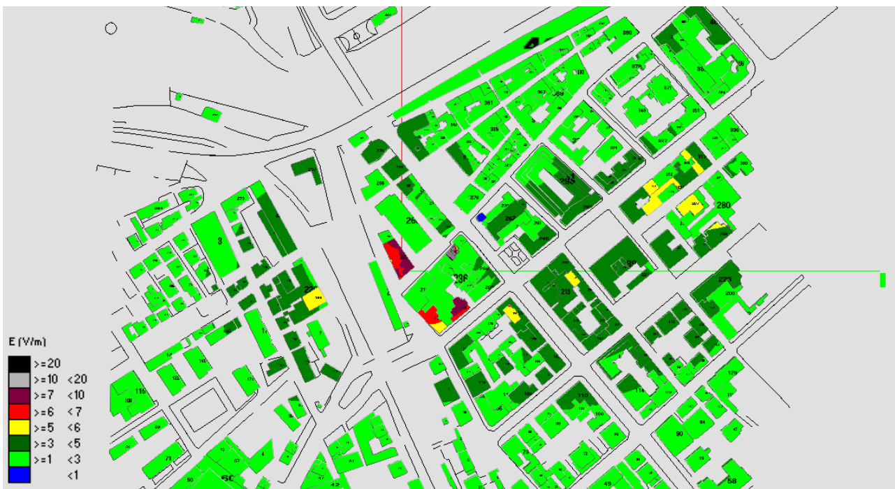
Fig. 116 Impatto elettromagnetico – zona Via dei Bastioni – Via Saline – Vista dall'alto
