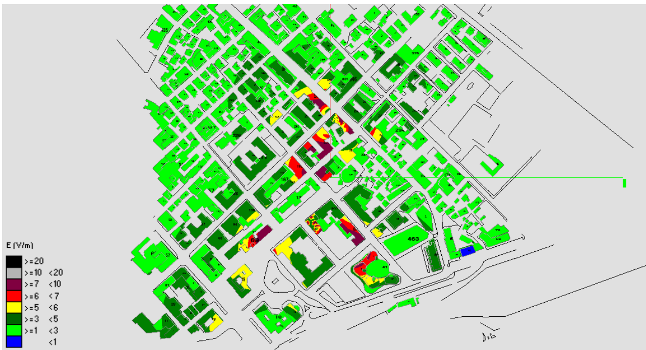
Fig. 111 Impatto elettromagnetico – zona Via Venezia – Via Palermo – Via Ostuni – Vista dall'alto
