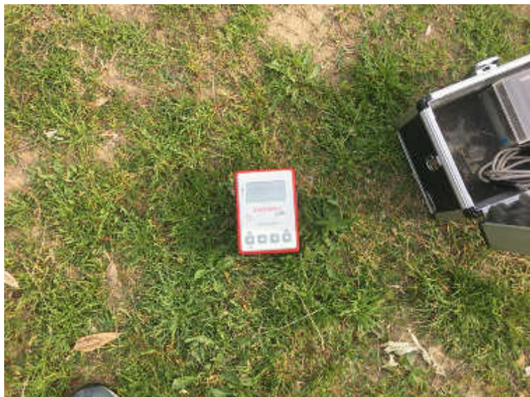
Foto 6.3: particolare del sistema di acquisizione dati (Tromino)
